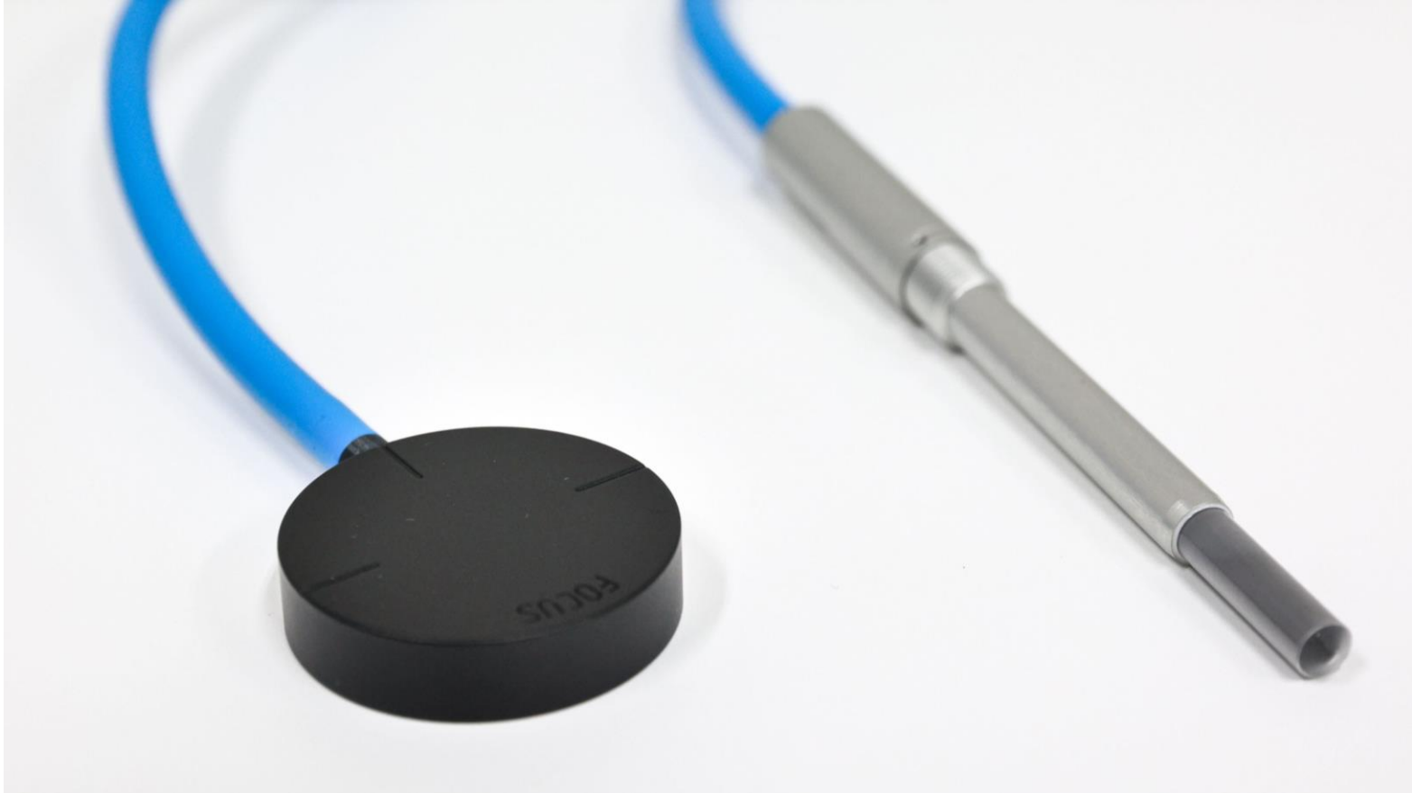
図 1.1 放射線線量計測で使用される円筒形電離箱（右）および平行平板形電離箱（左）
