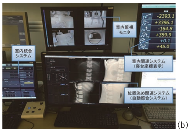
Fig.2 位置決め関連システム(a)とその周辺機器(b)
