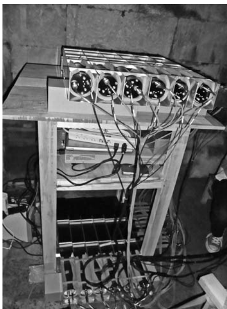
図6：ミュオグラフィ観測装置
