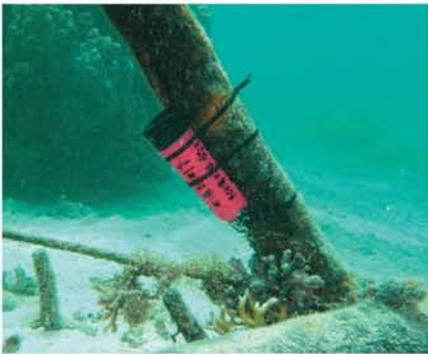
写真2 C1における水温ロガー設置状況
