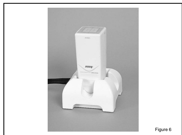
図6：CdTe半導体放射線検出器を搭載したガンマカメラ（MGC500、アクロラド、うるま）
