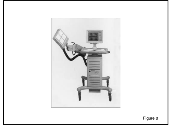
図8：光電子増倍管以後を半導体素子に置き換え た可搬型ガンマカメラ(2020tc, Digirad, CA)
