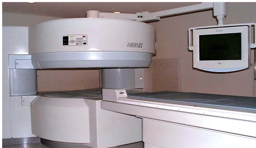
Fig1. インルームモニターはオープン型 MRI 装置と一体となっている。
