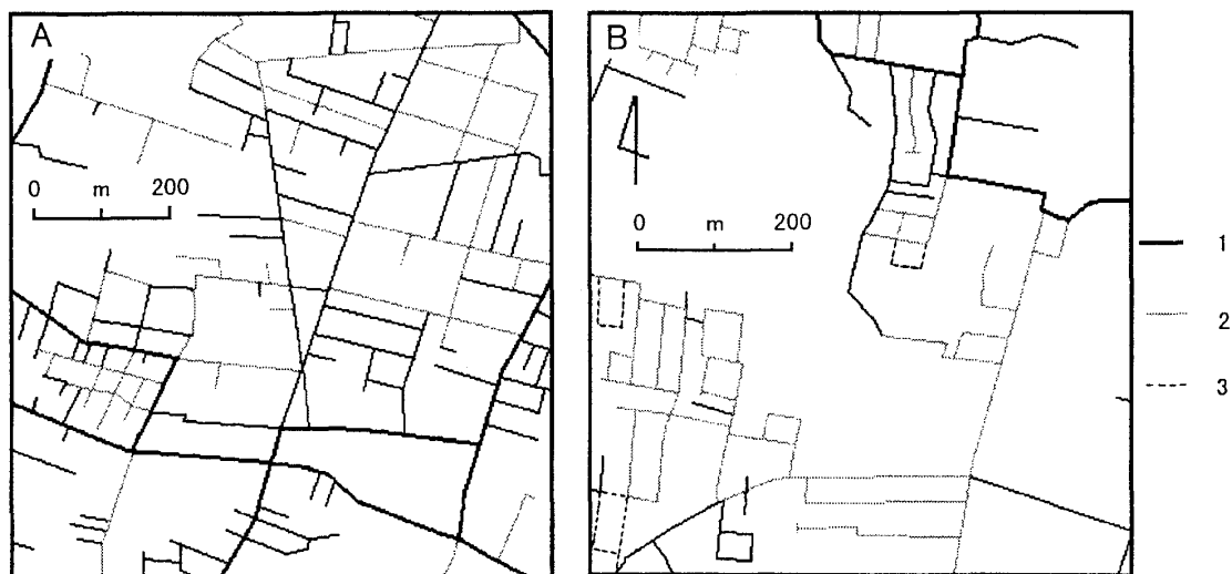
図11 ミニ住宅開発地内道路の整備状況（1997年） A：大網白里町南横川地区 B：茂原市粟生野・弓渡地区 1 県道・市道 2 「2項道路」 3 「位置指定」道路 （千葉県山武土木事務所及び長生土木事務所管内資料を基に作成）
